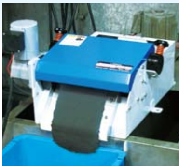
スラッジ排出状況
